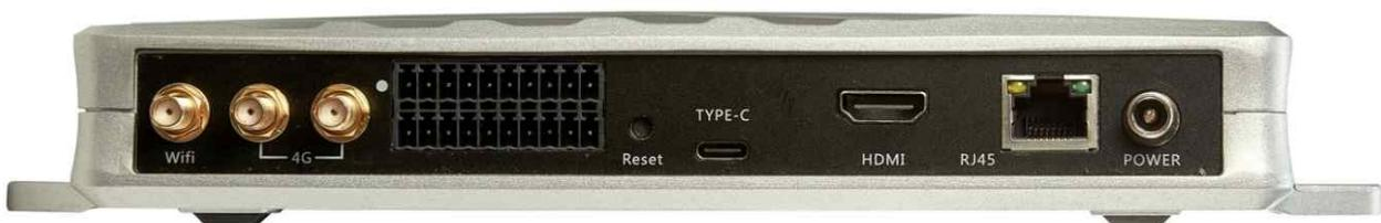
**HF340/380** 는 최신 IoT 스마트 UHF RFID Reader 제품입니다. Impinj INDY R2000 고성능 RFID 칩셋을 탑재하고 Android 9 운영체계를 내장했습니다. 4-Port(HF340), 8-Port(HF380) 제품으로 구성됩니다. 오프라인(단독운영)으로 작업할 경우 40,000 여개의 Tag 정보를 2GB RAM 과 16GB ROM 에 저장할 수 있습니다. USB, RJ45, RS232 및 WiFi 와 Bluetooth 무선 접속을 지원하며 POE 를 옵션으로 지원합니다. 또한 HDMI 포트를 이용해 모니터와 연결할 수 있습니다.
